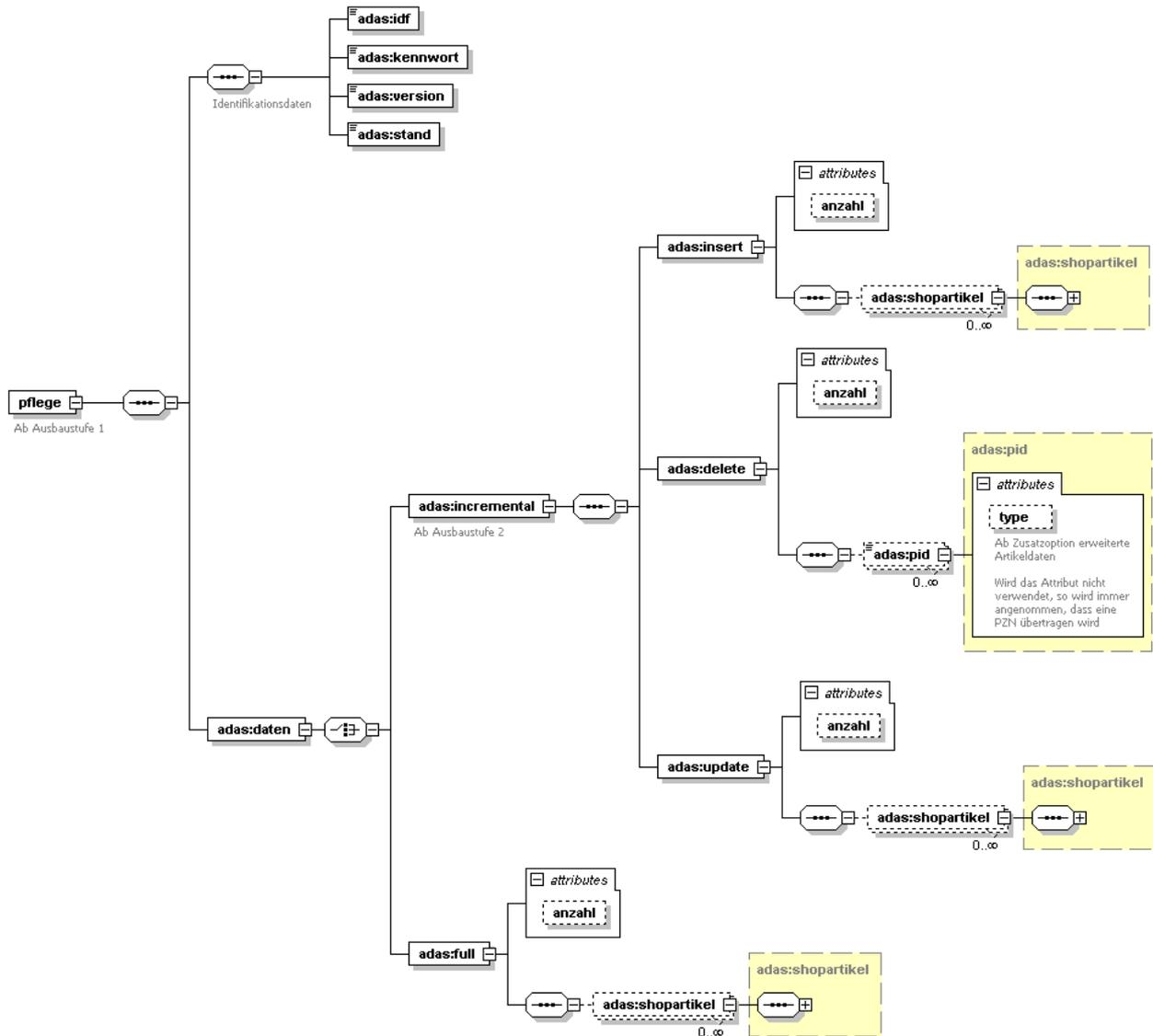
Während bei der *Standardstufe* bei jeder Datenaktualisierung die neuen Daten als Komplettpaket mit entsprechend großem Datenumfang gesendet werden gibt es bei gleichem Datenstand auf beiden Systemen die Möglichkeit, nur die Änderungen zu übertragen. Diese Änderungen lassen sich in drei verschiedene Themenbereiche gliedern: Neue Datensätze, gelöschte Datensätze und zu ändernde Daten. Diese sind jeweils in den drei Elementen **insert**, **delete** und **update** enthalten.
